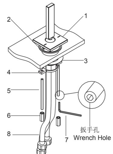
把软管(8)接到水源，有蓝色标志的软管接冷水，红色标志的软管接热水。
