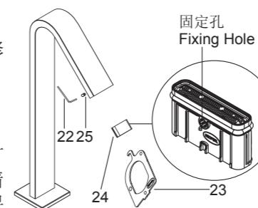
用1.5mm六角扳手(22)旋松螺钉(25)，用工具(23)小心地卸下起泡器(24)，打开水龙头，让水流过出水口一分钟以清除杂质。冲洗起泡器，关闭水龙头，保持固定孔朝下重新装回起泡器。
