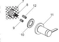
把所选齿套按在阀轴(8)上,将垫片(10)套在阀体(7)上。将把手组件(11)旋到阀体上,直到把手接触到墙面(注:面向龙头时,带红色垫片的把手安装在左侧)。
