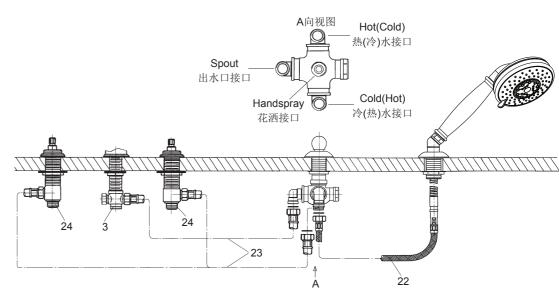
在软管(22)的连接螺母内放入垫片,并将其锁紧到切换器的花洒接口上。在软管(23,长1米)的两端连接螺母内分别放入垫片,连接T型接头(3)和切换器的出水口接口,然后连接两阀体(24)和切换器的冷热水接口(冷热接口可互换)。锁紧所有的连接螺母。
