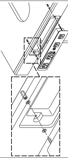
**4** Plug the electrical cord into a properly grounded outlet. Use the provided clamps as needed to secure the cord. Brancher le cordon électrique sur une prise mise à la terre de manière adéquate. Utiliser les brides fournies selon les besoins pour sécuriser le cordon.
