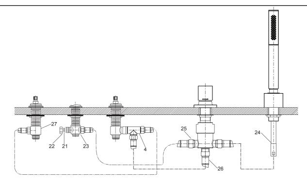
把垫片(21)放入螺母(22),并将其旋到所选配浴缸出 水口的T型接头(23)的任意端口上锁紧。
