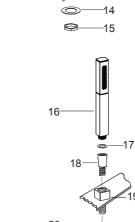
将花洒软管(18)(长2m)穿过导向套(19) 连接到连接软管(20)(长0.6m)上。
