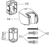
依据胀塞(11)直径打孔,安装胀塞。
