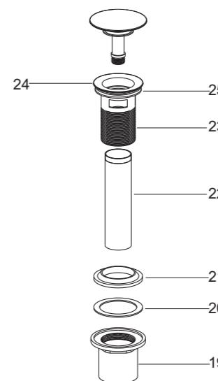
**注意：**如果需要，可直接在法兰盘(24)底面沿周围涂一圈密封油灰或其它密封剂，而不使用橡胶垫片(25)。
