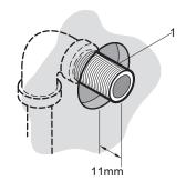
为使安装顺利,客户应自备G1/2"外螺纹接头(1)。接头露出墙外的长度为11mm。接头与装修好的墙面之间空隙最大为10mm,墙面开孔尺寸最大为41mm。
