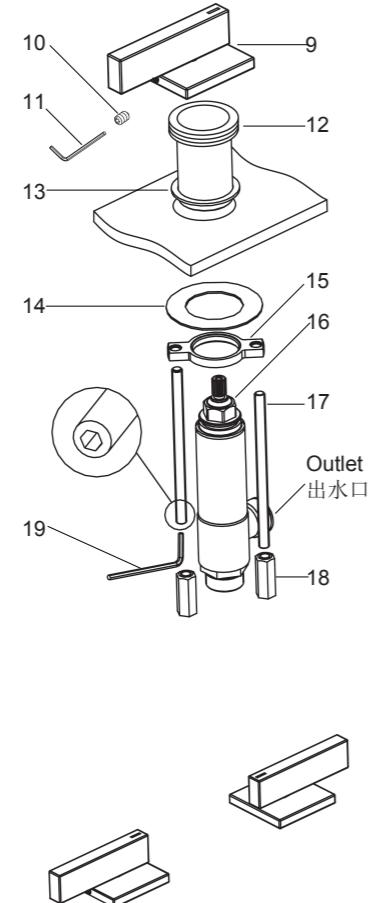
将把手组件(9)安装到装饰盖底座(注意：带有红色标记的把手组件装在左侧，且安装前阀芯处于关闭状态)。用2mm六角扳手(11)将螺钉(10)锁紧固定把手。
