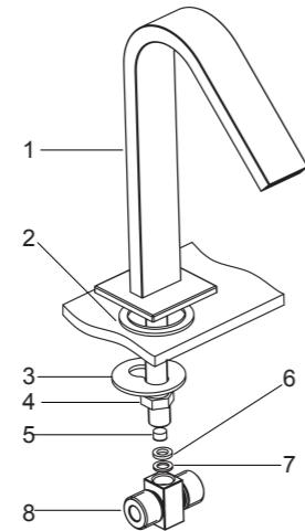
将橡胶垫片(2，外径45mm)装到出水口装饰盖底部凹槽，然后将出水口装于脸盆中孔。从脸盆下方安装钢垫(3)和螺母(4)。找正出水口，用扳手拧紧螺母固定出水口组件。装回T型接头。
