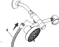
将软管(5)的一端连接到头顶花洒,另一端连接到手持花洒(6)。
