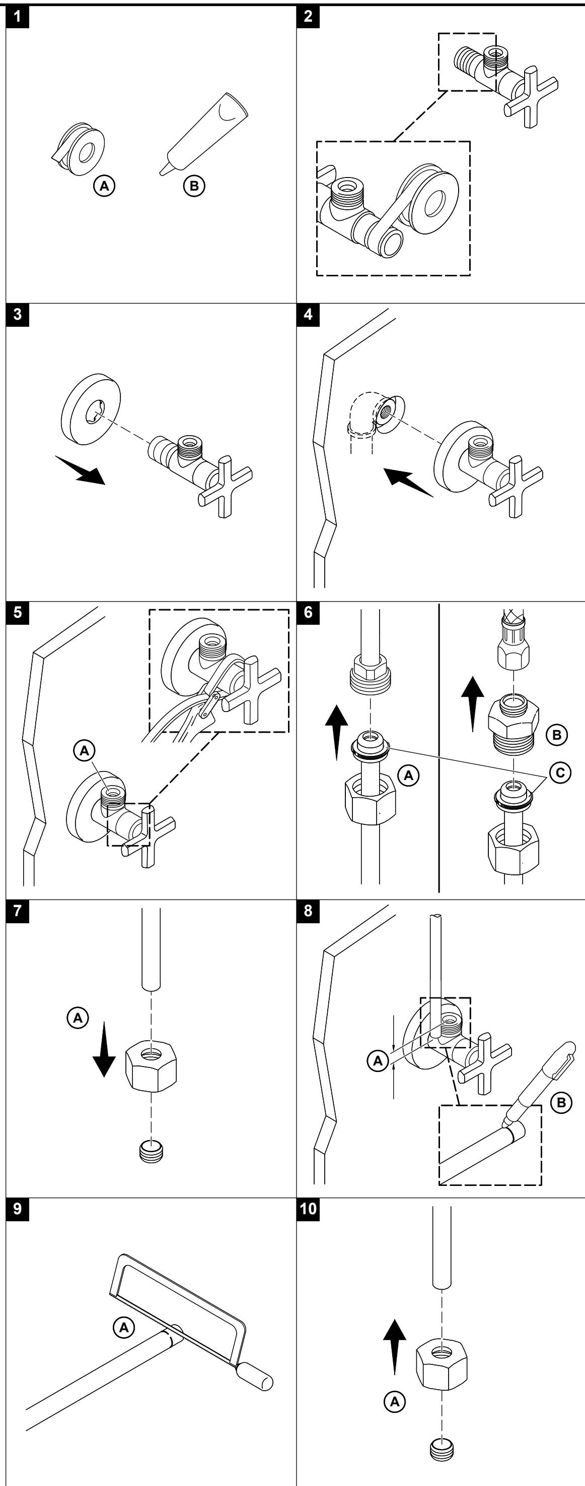
**14A.** Appuyer la rosace contre le mur et appliquer du mastic d'étanchéité à la silicone autour de la rosace au besoin.
