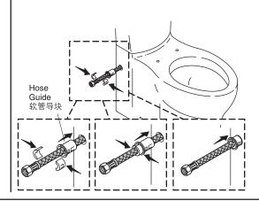
11 Slide the metal washer and the rubber washer onto the bolt. 将金属垫片和橡皮垫片套在螺栓上。
