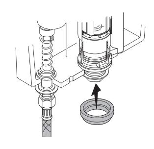
**9** Position the tank on the bowl. 将水箱放置在缸体上。
