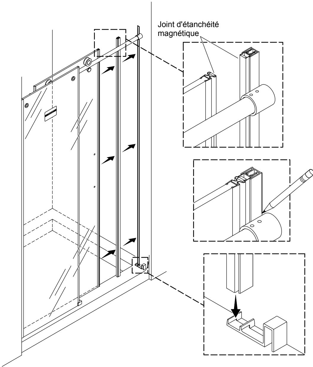
**REMARQUE :** Le montant avec gâche doit bien s'adapter contre le couvercle du seuil et le mur.
