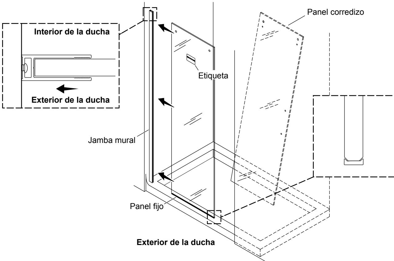
**AVISO:** El panel fijo no queda bien asegurado en la jamba mural mientras el sello en cuña y el dintel no hayan sido instalados. Tenga cuidado mientras completa la instalación.
