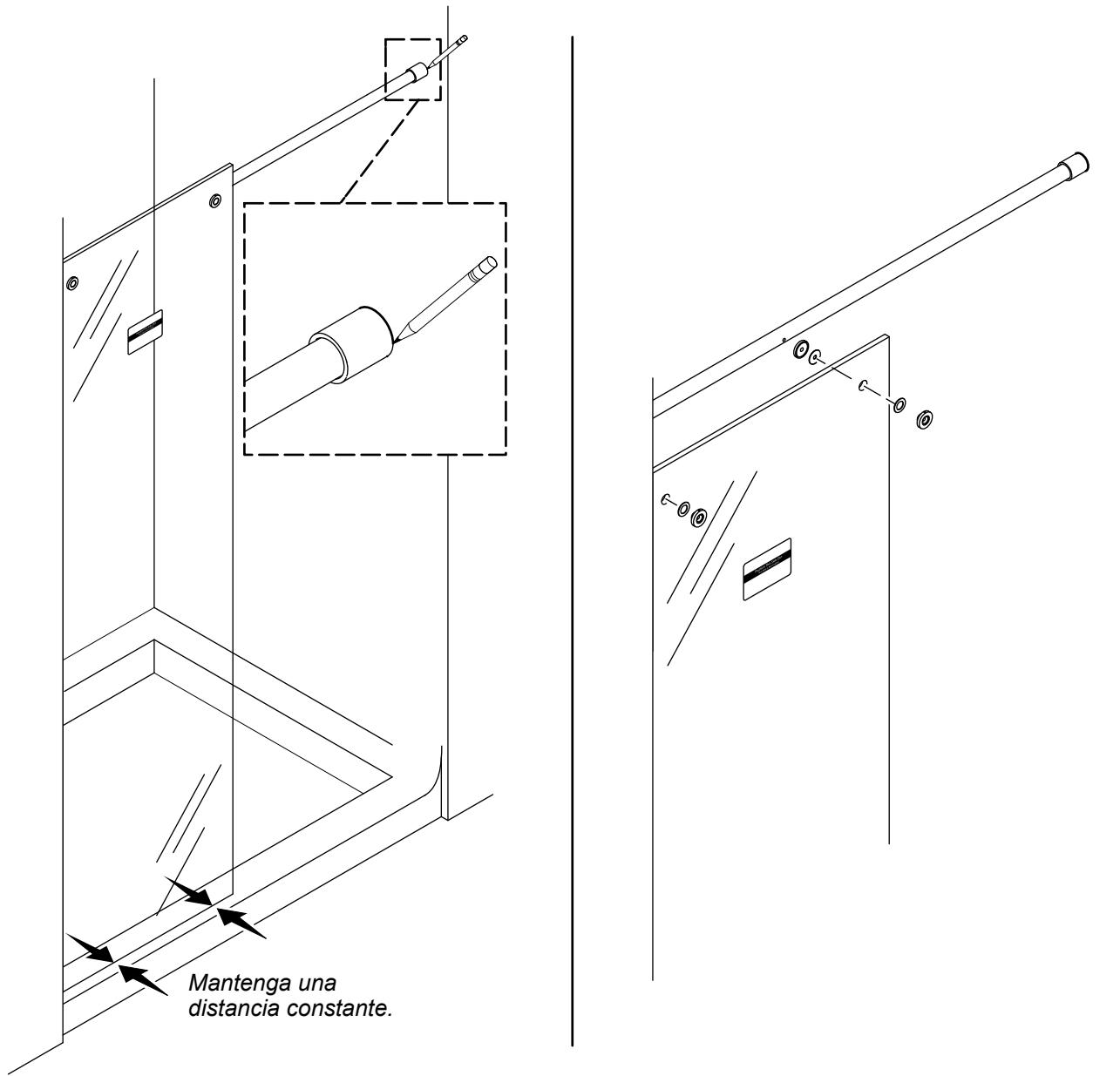
**AVISO:** El dintel debe quedar nivelado y bien asegurado al panel fijo. Si es necesario, vuelva a la sección "Nivele el dintel".
