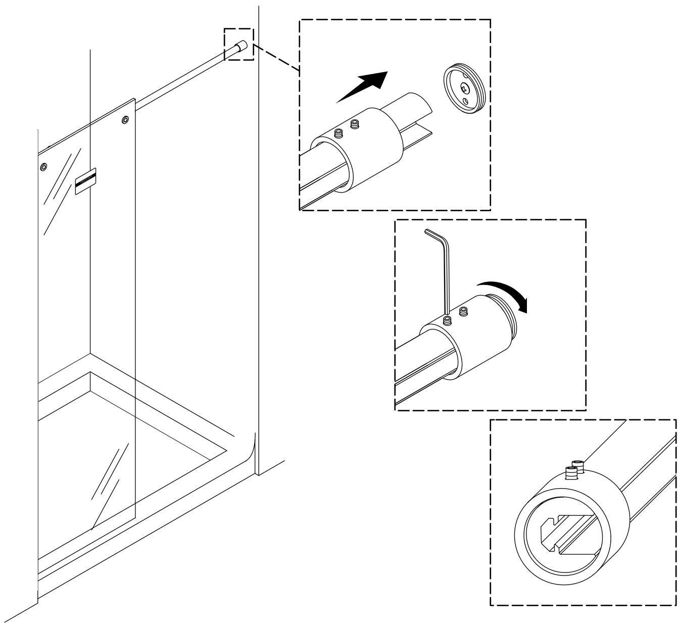
**IMPORTANT!** Ne pas forcer pour aligner le linteau sur le support mural. Si le linteau ne s'aligne pas, vérifier que le linteau est à niveau et que le panneau mural fixe est assis correctement. Si nécessaire, effectuer quelques petits ajustements selon la section « Mettre le linteau à niveau ».
