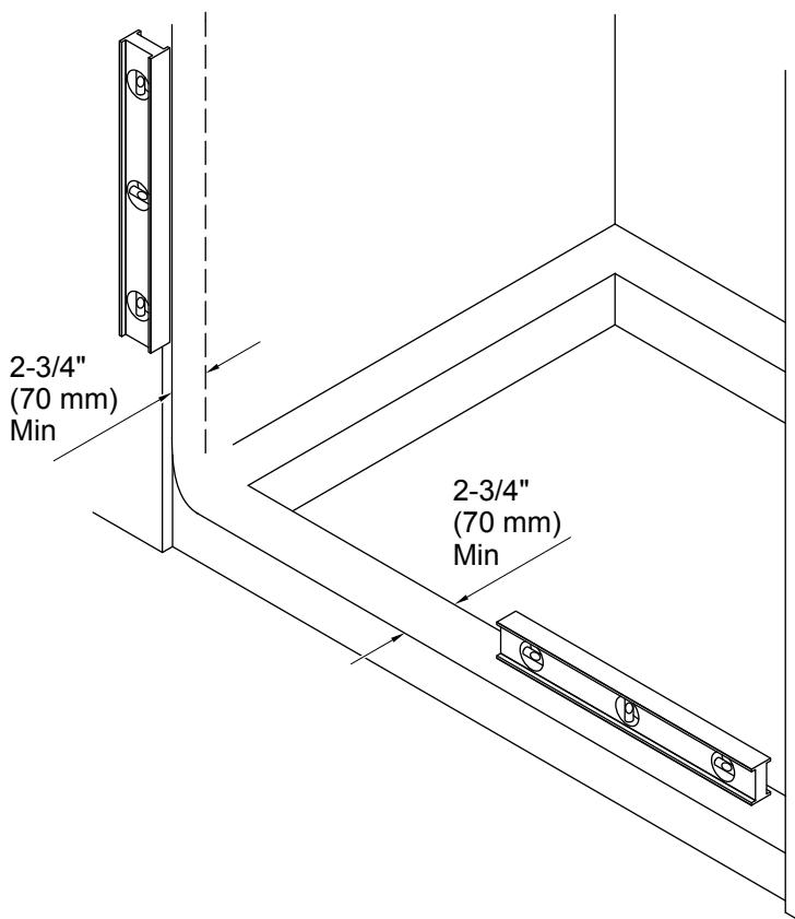
**IMPORTANT!** Pour un alignement et un fonctionnement adéquats de la porte, vérifier que les murs et la base de la douche sont conformes aux conditions requises suivantes. Ne pas installer la porte si ces conditions requises ne sont pas présentes.
