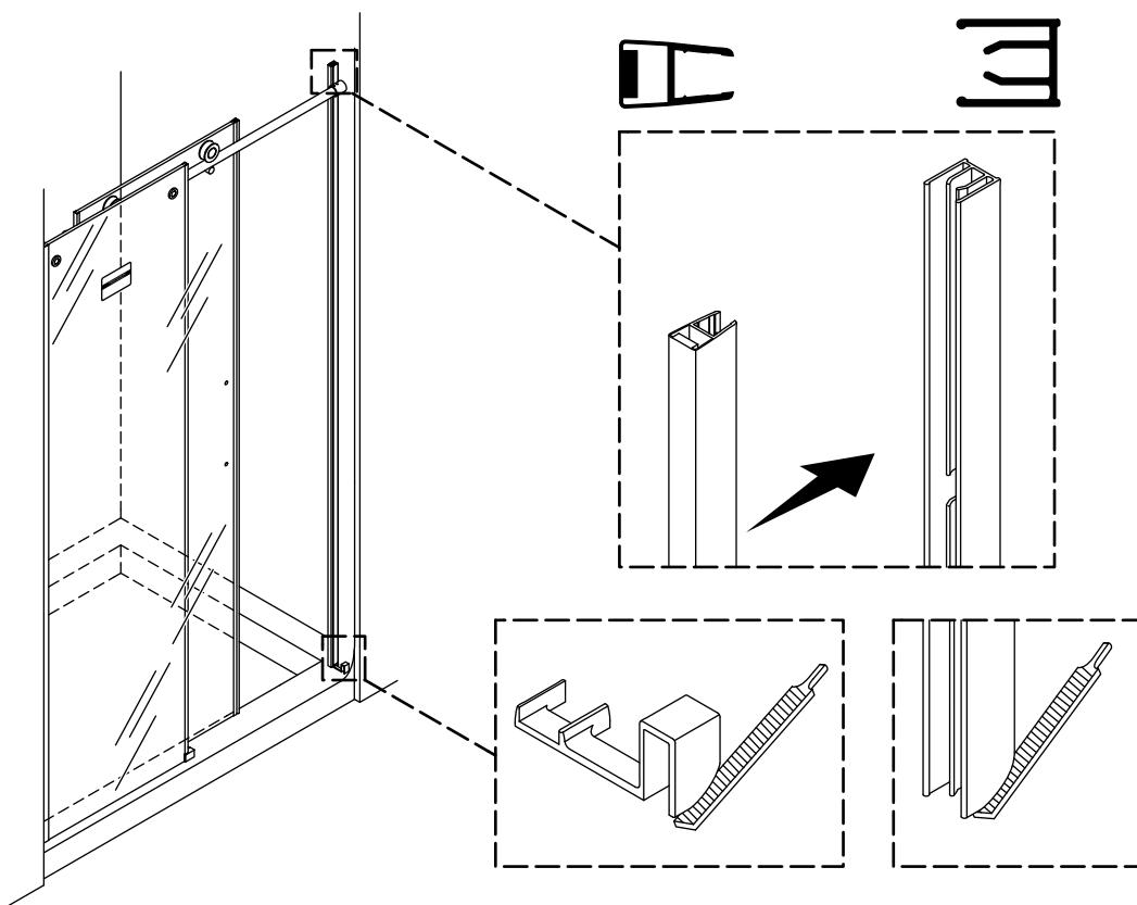
**REMARQUE :** Le montant avec gâche doit bien s'adapter contre le couvercle du seuil et le mur.
