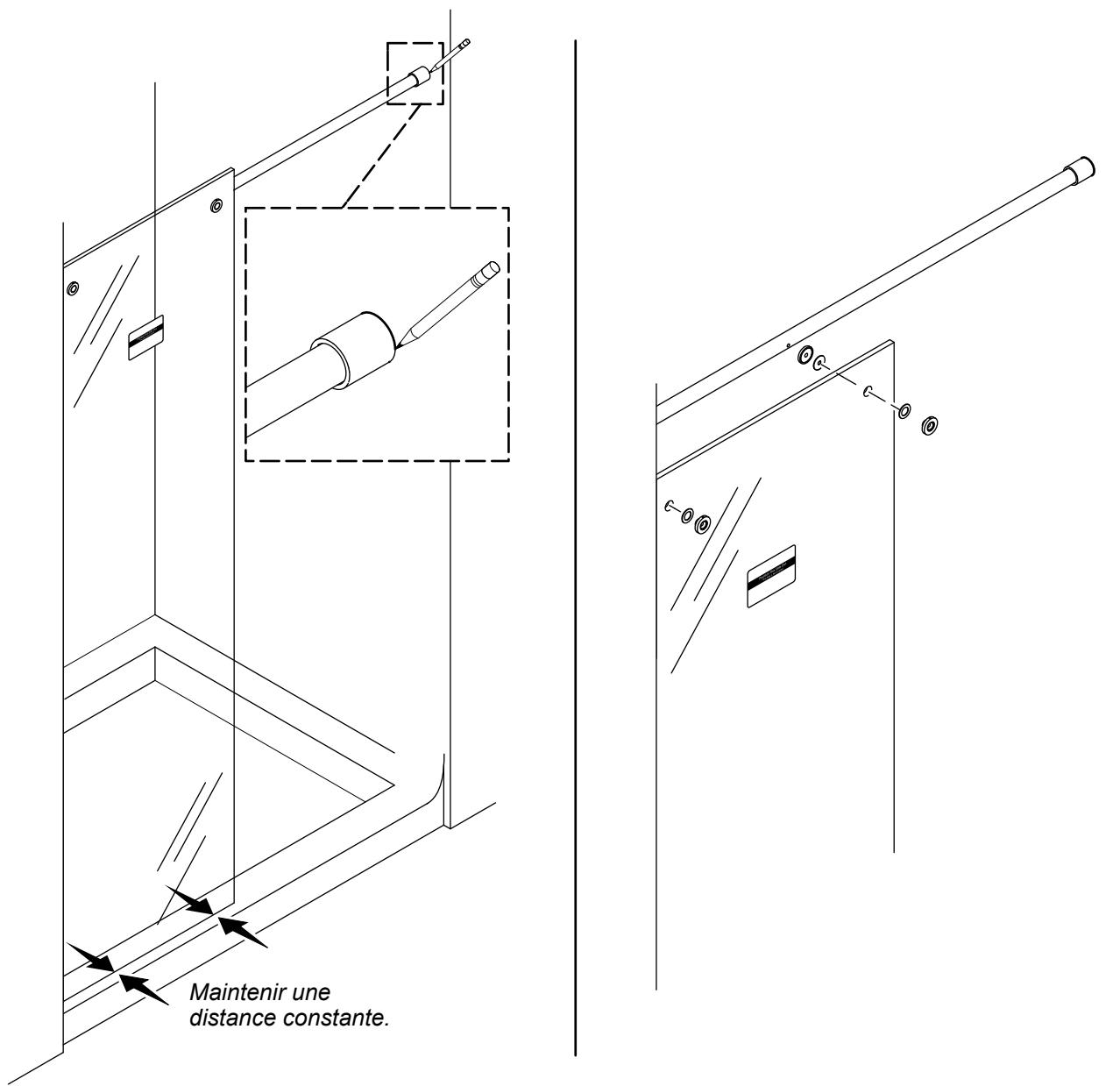
**AVIS :** Le linteau doit être à niveau et serré de manière sécuritaire sur le panneau fixe. Si nécessaire, retourner à la section « Mettre le linteau à niveau ».
