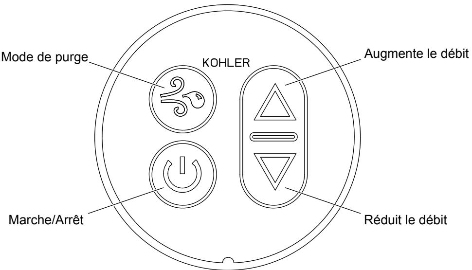
**IMPORTANT!** Ce produit comprend un mode de purge d'eau automatique qui met le souffleur en marche pendant 5 minutes après l'arrêt et la vidange du dispositif.
