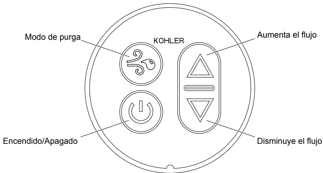
**¡IMPORTANTE!** Este producto tiene un modo de purga automática de agua que enciende el motor soplador durante 5 minutos después de apagar y vaciar la unidad.
