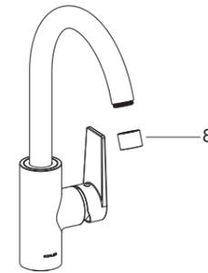
检查并确保所有的衔接处都已拧紧。确保把手在关闭的位置。
