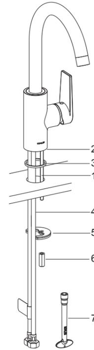
将固定螺栓(1)安装到水龙头底部(2)，把垫圈(3)装在水龙头底部，将软管(4)插入厨盆安装孔中。
