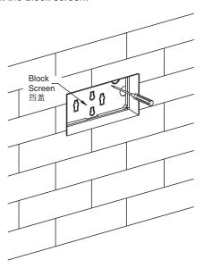
3. 如图用螺丝刀压在档盖的缺口上,取出挡盖。
