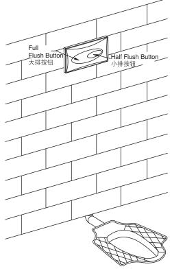
Finished Installation Illustration 安装完毕示图
