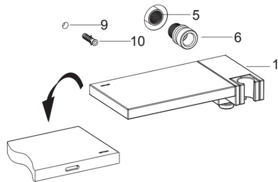
为了安装顺利，G1/2"内螺纹管道配件(5，客户自备)应已装好。**注意：**管道配件要垂直墙面，并且低于装修好墙面1~4mm，墙上孔径为30~35mm。
