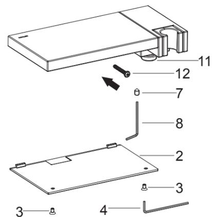
在托架背部涂一圈油灰或密封胶。将托架装到接头上，确保托架贴紧墙面且出水口(11)朝下。用六角扳手(8)旋紧螺钉(7)。
