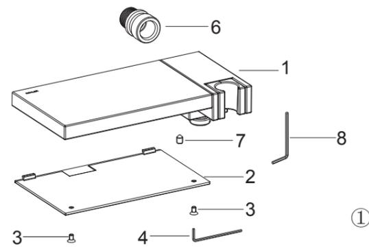
用六角扳手(4)取下花洒托架(1)底板(2)下面的两个螺钉(3)，取下底板。
