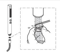
取下软管接头内的滤网垫片, 去除杂质。
