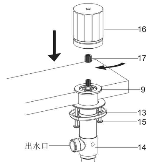
根据软管安装需要适当调整阀体出水口朝向。用螺丝刀拧紧螺钉(15)以固定阀体组件。
