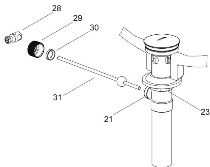
将接头(28)及固定螺母(29)取下,把塑料垫圈(30)及固定螺母装在球杆(31)上,把球杆组件插入排水杆的洞口中并穿过止水塞,拧紧固定螺母。
