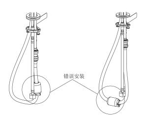
将铜坠(10)和卡扣(12)装到软管组件(11)上,通过转换接头(13)连接软管组件与铜管(14)。将卡扣和铜坠移动并固定在合适的位置。**注意**:不要过份扭曲软管。请避免将铜坠和卡扣安装到下图错误的位置。
