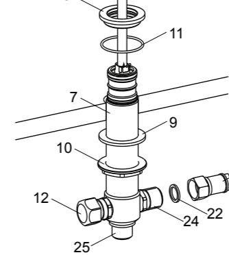
将垫片(22)装入软管(23)接头内，然后用软管连接阀体组件接头(4)和切换器组件接头(24)。
