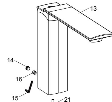
从水口组件(13)上取下塞扣组件(14)，用六角扳手(15)拧松紧固螺钉(16)直至切换器组件可以装入出水口组件。将切换器组件装入出水口组件，调整出水口位置，使出水口朝向正前方。用六角扳手拧紧紧固螺钉，安装塞扣组件。
