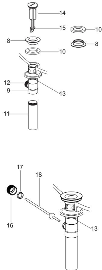
**注意:** 在锁紧螺母拧紧后,如法兰盘使用密封油灰,则不可以调整排水本体的位置,否则会破坏油灰密封的密封性。同时去除多余油灰。
