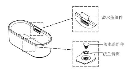
注意: 图示是带裙板浴缸。这些步骤同时适用于带裙板的浴缸和带底座的浴缸。
