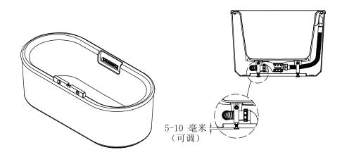
注意: 浴缸的重量必须由浴缸脚支撑。
