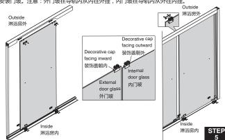
Install the handle and the top cover. 安装拉手以及顶盖。
