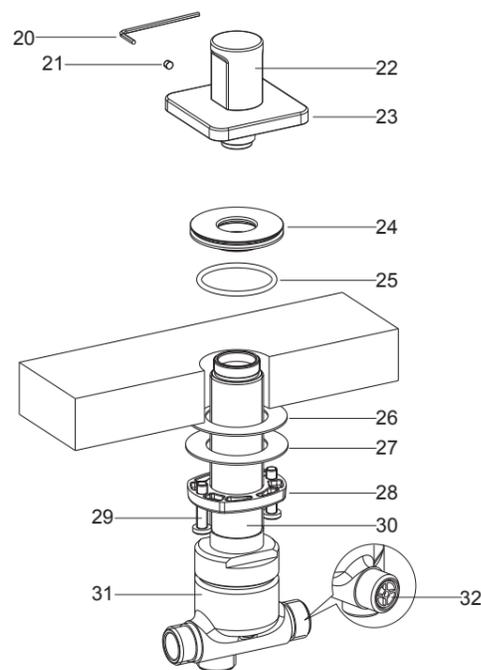
将螺钉(29)旋入安装环(28)螺钉孔。依次将安装环、钢垫(27)和垫片(26)装到连接杆(30)上。将分水器组件(31)从浴缸下方插入安装孔。
