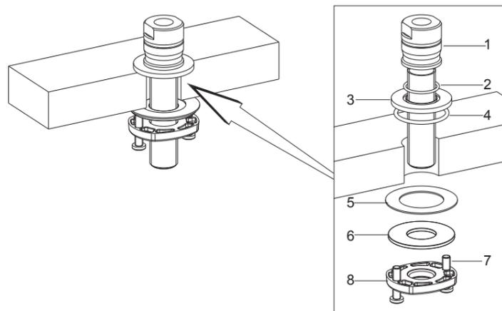
将螺钉(7)旋入安装环(8)螺钉孔。从浴缸下方依次安装垫片(5)、钢垫(6)和安装环, 拧紧螺钉(7)以固定牙管。
