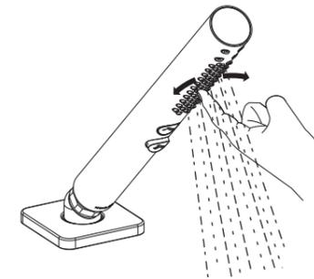
喷孔杂质或结垢会导致水流变形，流量变小。打开水源，用力按压或摩擦橡胶喷孔，去除杂质或水垢。
