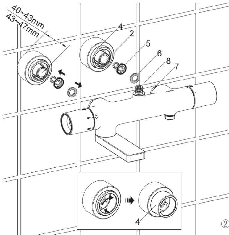
情形一：当接头(2)凸出墙面的距离是40~43mm时，将滤网(5)装到接头内。将垫片(6)装到螺母(7)内。
