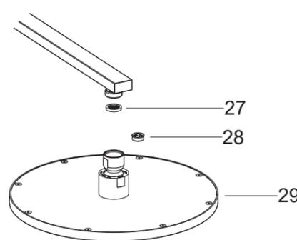
装头顶花洒(29)之前调整至头顶花洒出水状态，打开水源冲掉管路中的杂质。
