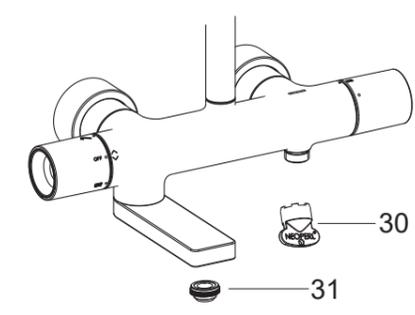
检查并确保所有的衔接处都已拧紧，确保手柄在关的位置。
