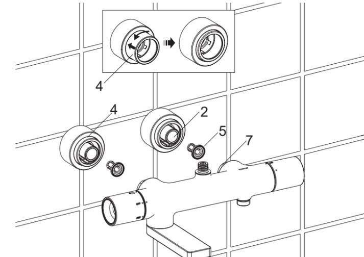
滤网(5)可起到保护龙头的作用，但长时间使用后，水垢或杂质可能会堵塞滤网，降低水流量。
