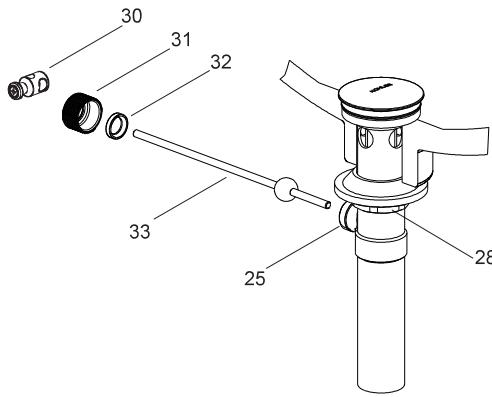
将连接头(30)及固定螺母(31)取下，把塑料垫圈(32)及固定螺母装在球杆(33)上，把球杆组件插入排水杆的洞口中并穿过止水塞，拧紧固定螺母。
