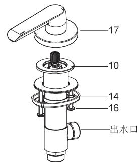
根据软管安装需要适当调整阀体出水口朝向。用螺丝刀拧紧螺钉(16)以固定阀体组件。
