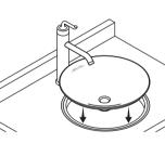
9. 放置面盆,使商标位于靠墙一侧。擦除多余 的密封胶。等待密封胶固化。
