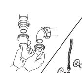
11. 连接进水管和落水。
