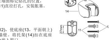
旋紧螺钉(12), 使底座(13, 平面朝上) 固定紧贴墙壁。将托架(14)扣在底座 上, 使凸台嵌入豁口。
