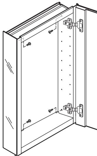
B. 用圆头短螺钉将支架固定。
