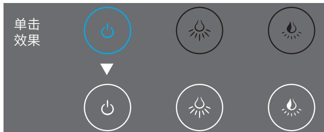
2. 点击电源键后，镜灯缓慢亮起，传感器处于关闭状态。亮度及色温键亮白色，可单击换级/长按无级循环调整，同时防雾膜开启。
