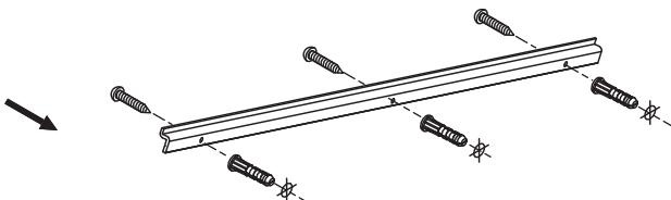
B. 安装托条，水平放置并固定。 螺钉孔数量以实物为准。
