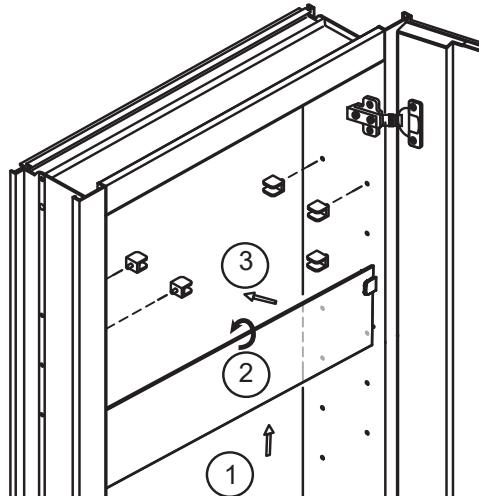
A. 安装夹子，将层板玻璃垂直插入层板夹，再旋转水平后推入另一排层板夹中。
