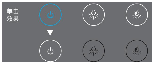
3. 在镜前再次点击电源键后，镜柜灯光缓慢熄灭，防雾膜延迟30分钟关闭。按键恢复出厂上电状态，亮度及色温键熄灭，不可调节。
