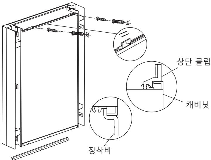
C. 장착바를 설치합니다. 수평으로 놓고 고정합니다. 나사 구멍의 개수는 실제 제품을 기준으로 합니다.
