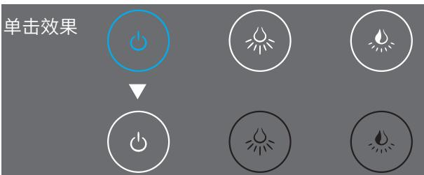
4. 在自动模式下短按电源键，则会直接关闭镜灯，并让系统恢复为手动模式。此时关闭镜灯，系统恢复为手动模式，回到手动上电初始状态。
