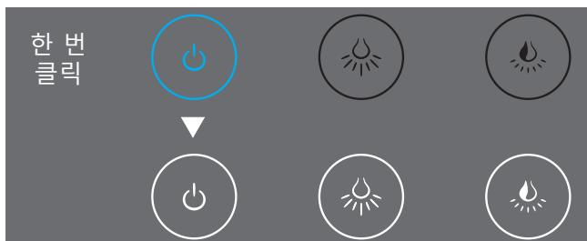
2. 전원 버튼을 누르면 표시등 서서히 켜지고 센서는 꺼진 상태로 유지됩니다. 밝기 및 색상 온도 버튼이 흰색으로 켜지면 버튼을 눌러 밝기 및 색온도를 전환하거나 버튼을 길게 눌러 조정할 수 있습니다. 김서림 제거 장치가 동시에 켜집니다.
