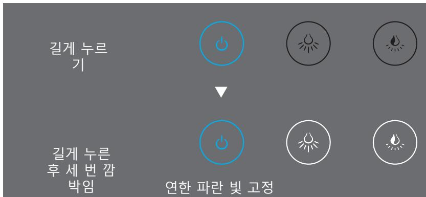
1. 전원 버튼을 2초 동안 누릅니다. 파란색 조명이 세 번 깜박인 후 조명이 자동 모드가 되고 전원 버튼은 파란색으로 켜집니다. 센서가 작동합니다 (거울 앞에 사람이 있는지 감지). 조명이 자동으로 켜집니다. 밝기 및 색상 온도 버튼이 흰색으로 켜지면 버튼을 눌러 밝기 및 색온도를 전환하거나 버튼을 길게 눌러 조정할 수 있습니다.
