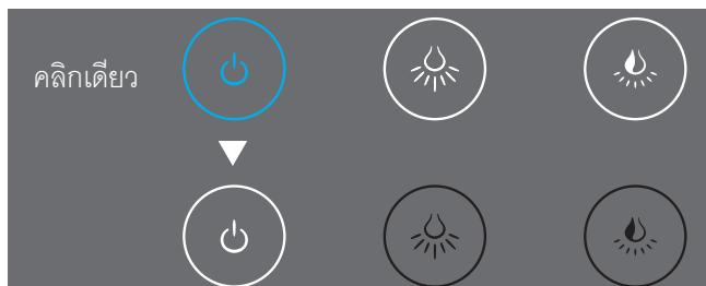
3. เมื่อกดปุ่ม เปิด-ปิด คือครึ่ง หลอดไฟจะค่อยๆดับลงและไฟจะปิดหลังจากนั้น ๓๐ นาที ปุ่มกดจะอยู่ในสถานะเริ่มต้นการทำงาน ไม่สามารถปรับความสว่างและโทนสีได้
