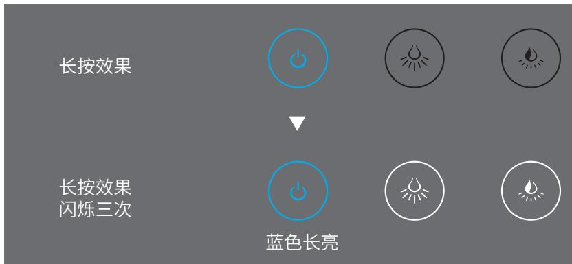
1. 长按电源键2秒，蓝色效果闪烁三次后，镜灯进入自动模式电源键变为蓝色。此时传感器启动(同时感应到人)，镜灯自动随之亮起。亮度/色温键亮白色，可供单击换级/长按无级循环调整。
