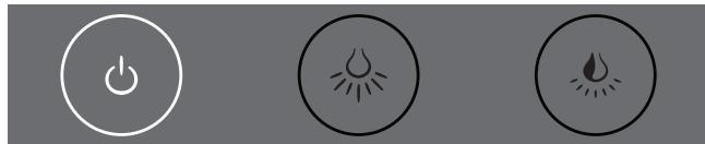
1. เมื่อนำมาใหม่ด้วยค่าเริ่มต้นการทำงาน หลังจากจ่ายกระแสไฟฟ้า หลอดไฟอยู่ในสถานะปิดและไฟสถานะปุ่ม เปิด-ปิด แสดงสีขาว
