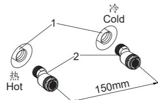
在两个接头(2)涂上密封胶或缠绕足以密封的密封胶带, 旋入冷热水管中。调节两个接头, 使其中心距离为150mm, 并保持同一水平。它们凸出墙面的尺寸应该在34到44mm之间。
