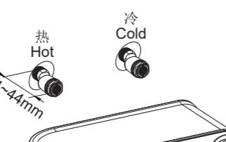
用5mm六角扳手(3)调整两个紧固螺钉(4), 将龙头本体插入两个进水接头, 使本体贴紧墙面。
