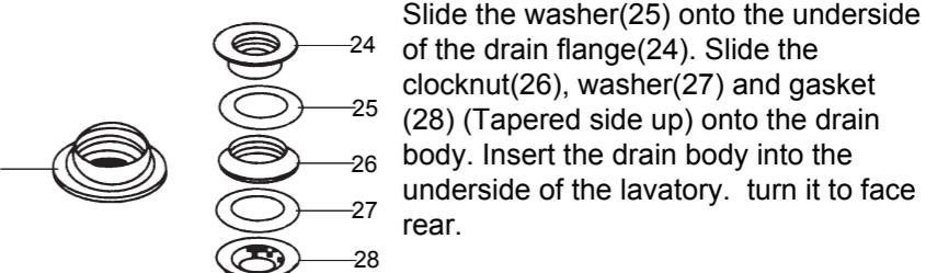
**注意：**如果需要，可直接在排水器盘片底面沿周围涂一圈密封油灰，而不使用垫片(25)。
