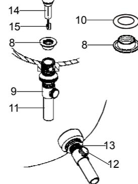
把止水塞(14)放入排水本体中，调整止水塞末端的洞口(15)使其靠近并对正排水杆的洞口。
