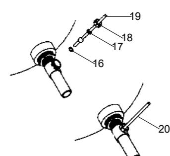
确定球动杆指向洗面盆后方，再次拧紧排水本体的锁紧螺母(13)，去除多余油灰。
