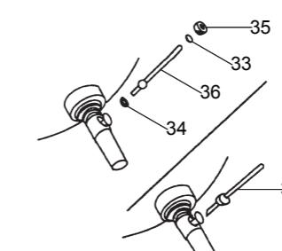
**注意：**在锁紧螺母拧紧后，不可调整排水本体的位置，否则会破坏油灰密封或密封剂密封。
