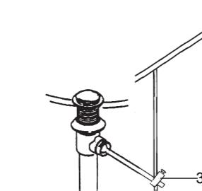
把连接头(38)安装到提拉杆上，将球杆装入连接头，把球杆往下推到排水器全开位置，调整提拉头到合适位置，将装接头锁紧，固定在提拉杆上。
