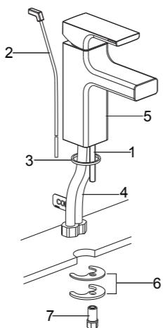
把软管接到水源。当面对龙头时，左边接热水源，右边接冷水源，冷水管贴有“COLD”签。
