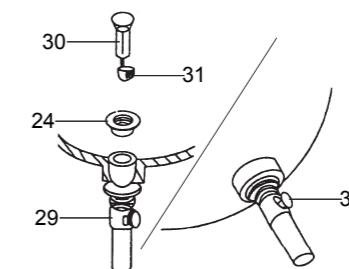
把止水塞(30)放入排水本体中，调整以使止水塞末端的洞口(31)靠近并对正排水杆的洞口(32)。
