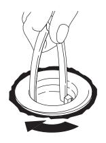
将钳子的手柄插入过滤网的顶部,拧紧下水弯头,如图所示。确保下水弯头等正对着浴缸的前端。然后在下水弯头外围四周打上密封硅胶。
