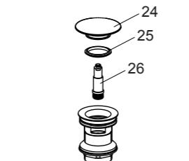
逆时针旋下止水塞(24), 然后取出止水垫(25)。更换新的止水垫。逆时针旋下活塞组件(26), 更换新的活塞组件。装回止水垫及止水塞。
