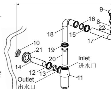
如果连接螺帽不能与排水器螺纹相连, 则需要旋松连接螺帽(15), 调节弯管(17)伸入弯管(18)的长度。依次锁紧连接螺帽(15, 19, 22)以固定去水弯管。
