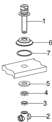
从浴缸下方安装垫片(5)、螺母(4)和螺母(3)，上下同时用力拧紧螺母(4)，然后拧紧螺母(3)。将T型接头旋到牙管上，直至用手旋紧。
