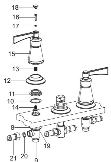
将橡胶垫片(10)和带O型圈的螺母(11)装到每个阀体组件上。将装饰盖(12)旋紧到螺母(11)上。将齿套(13)按在阀轴(14)上，然后将把手(15)按在齿套上。用螺钉(16)带垫片(17)固定把手。将塞扣(18)塞入把手顶部的孔中。用扳手将螺母(19)锁紧。
