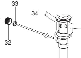
将固定螺母(32)取下，把塑料垫圈(33)及固定螺母装在球杆(34)上，再把球杆组件插入排水杆的洞口中并穿过止水塞，拧紧固定螺母。
