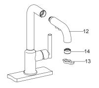
将花洒(12)拆下,用工具(13)将起泡器(14)拆下。打开水龙头,让水流出约一分钟以清除杂质。冲洗花洒的滤网垫片及起泡器。关闭水龙头,重新装回起泡器和花洒。
