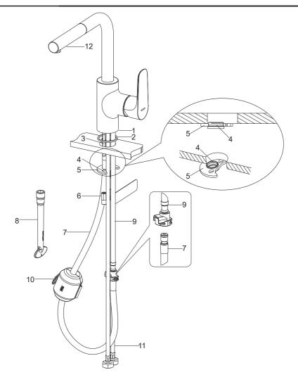
将螺栓(3)拧紧到水龙头本体(1)底部,将垫圈(2)穿过螺栓嵌入水龙头本体底部的槽中。将软管及本体组件装入洗涤盆的安装孔中。使龙头本体的底部接触台面。
