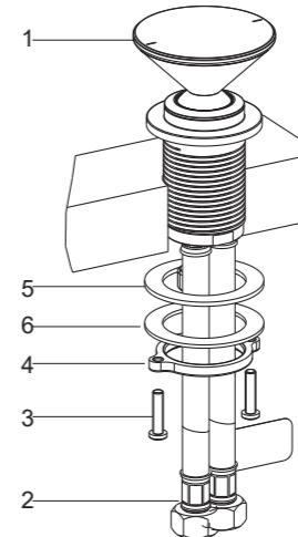
确保螺钉(3)部分旋入安装环(4)。从浴缸下方依次安装垫片(5, 6)和安装环(4)。
