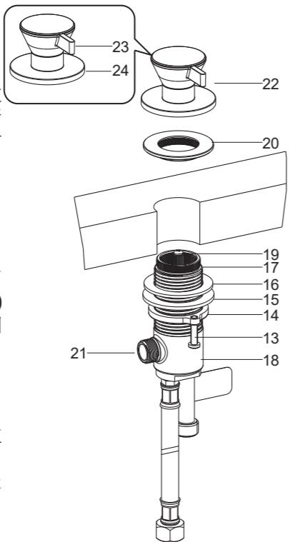
确保阀芯(19)是关闭状态，从浴缸上方将螺母(20)旋到牙管上。拧紧螺钉(13)以固定本体组件。**注意：**接头(21)朝左边。
