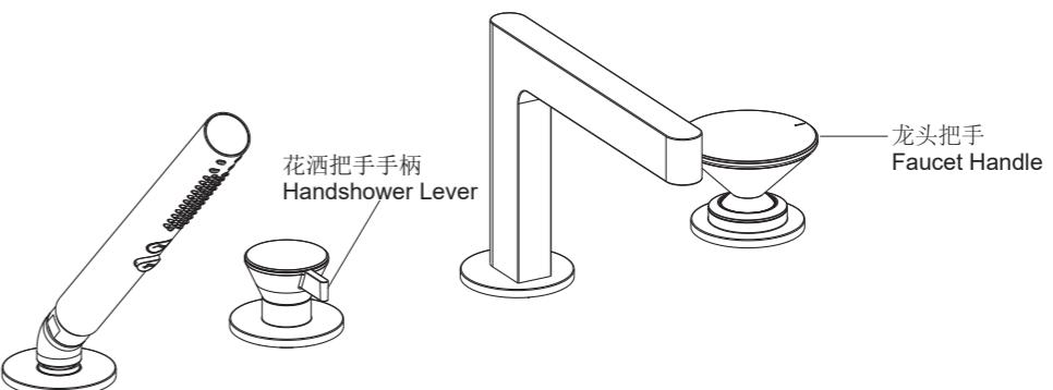
将龙头把手轻轻往后推，浴缸出水口出水，顺时针旋转为热水，逆时针旋转为冷水。
