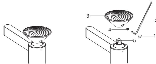
取出塞扣(1)，用六角扳手(2)旋松把手(3)里面的螺钉(4)。拔下把手。
