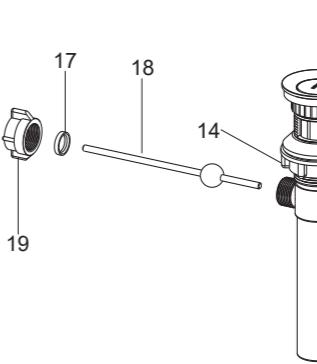
将固定螺母(19)取下，把塑料垫圈(17)及固定螺母装在球杆(18)上，再把球杆组件插入排水杆的洞口中并穿过止水塞，拧紧固定螺母。
