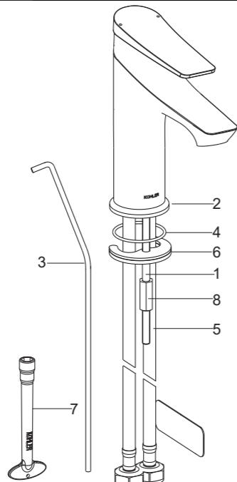
把软管接到水源，当您面对水龙头时左边为热水，右边为冷水，冷水管有“COLD”签。
