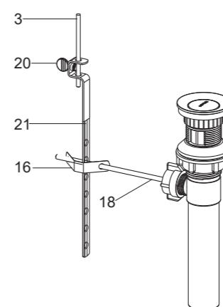
把手捻螺丝(20)装到联杆(21)上。用V形夹(16)将联杆连接到球杆(18)上，将提拉杆(3)插入联杆的孔中，将球杆下推至排水组件全开位置，调整提拉杆的位置。拧紧手捻螺丝(20)。
