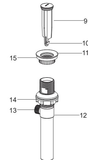
把止水塞(9)放入排水本体中，调整止水塞末端的洞口(10)使其靠近并对正排水杆的洞口。
