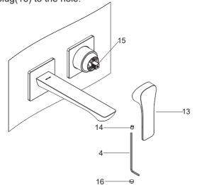
阀芯处于关闭位置时, 出水口和把手 安装完毕状态如图所示。
