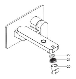
检查并确保所有衔接螺母都已拧紧,确保把手在关闭位置。打开排水器和主要供水源,检查是否有漏水。如有漏水,修理之。
