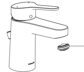
用硬币拆下起泡器组件(26)。打开水龙头冷热水，让水流约一分钟以清除杂质。冲洗起泡器组件，关闭龙头，重新装回起泡器组件。
