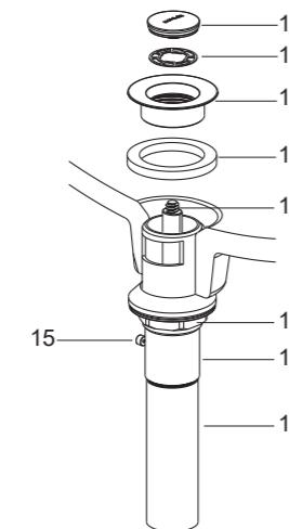
**注意：**如果需要可直接在法兰盘(12)底面沿周围涂一圈密封油灰，或其他密封剂，而不使用垫片(13)。
