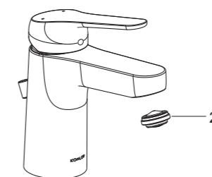
用硬币拆下起泡器组件(29)。打开水龙头冷热水, 让水流约一分钟以清除杂质。冲洗起泡器组件, 关闭龙头, 重新装回起泡器组件。
