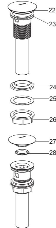
**注意:** 如果需要, 可直接在排水器法兰(22)底面沿周围涂一圈密封油灰或其他密封剂, 而不使用橡胶垫片(23)。
