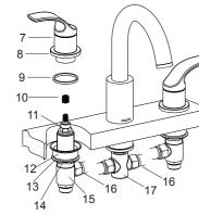
将垫片放入软管(16)两端,用软管连接 阀体组件与T型接头(17)。
