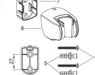
旋紧螺钉(6), 使底座(7, 平面朝上)固定 紧贴墙壁。将托架(8)扣在底座上, 使凸 台嵌入豁口。
