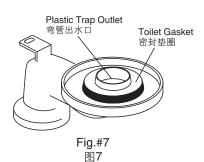
将密封垫圈紧套于弯管出水口。
