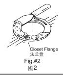
用涂油灰刀拆除地上的旧密封垫圈及座便器法兰盘,拆除及扔掉旧的T型螺栓。
