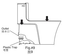
小心对准并将座便器向下放置。同时将 座便器边缘向下压,以使排水口插入弯 管中。为了要达到最佳的效果,请在安 装时确定座便器是否水平。
