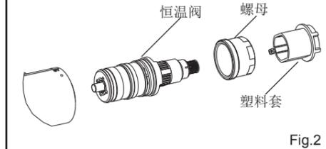
清洗后将塑料套和螺母(限位组件)装到温控阀上，使塑料套的定位柱嵌入温控阀的限位槽内。
