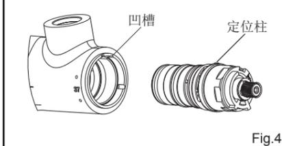
**注意：**确保拆卸、安装过程中不要转动温控阀轴。如不小心转动了阀轴，要调整阀轴使外齿上的圆孔标识与相邻的塑料套上的凹槽对齐，或者按前述方法进行调整。
