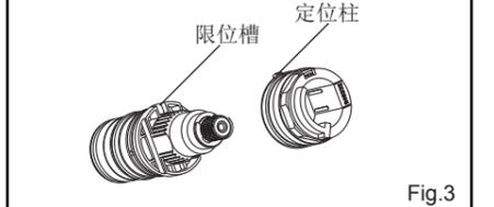
然后将塑料套的定位柱与龙头本体内孔凹槽对齐，装入温控阀并锁紧螺母。
