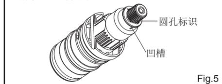
安装轴套及温控把手(不要转动温控阀轴)，使参考标识同数字37对齐，拧紧螺钉。安装把手上盖。
