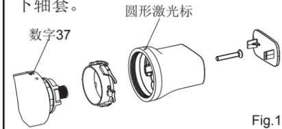
将螺母和塑料套卸下。小心地卸下温控阀。用热醋进行清洗。
